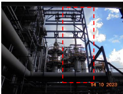
รูปที่ 3.2 ระบบ Phenol Scrubber (D-1903)
